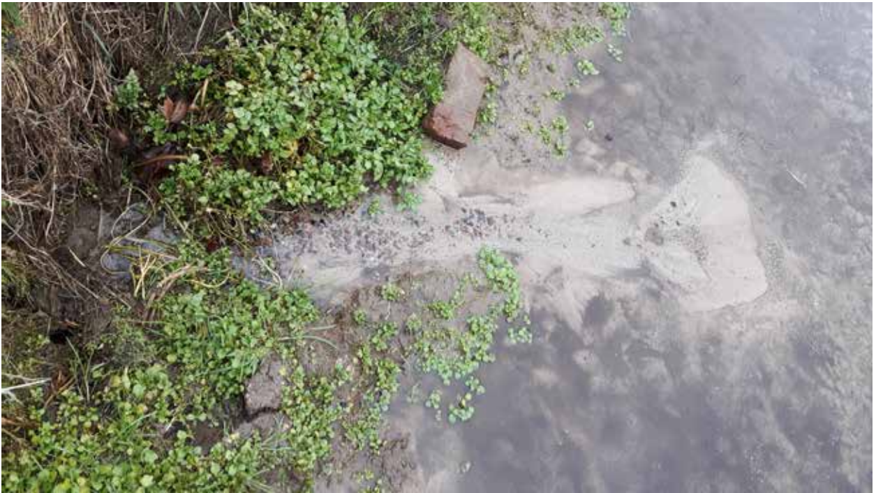
Fig. 3. Uitstroom van kwelwater onderaan de noordelijke oever van de afvoergreppel, juist achter de voormalige stuw. Foto Gerard Majoor.
